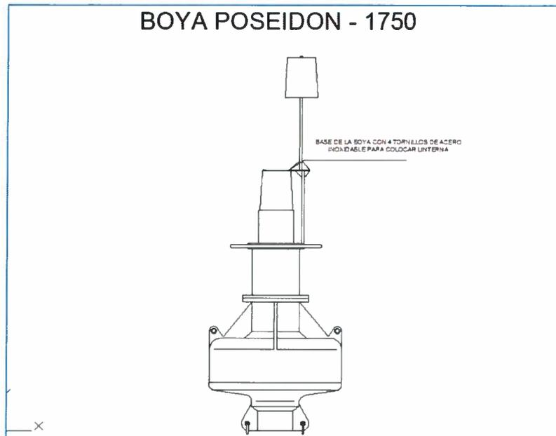
Figura 3. Boya de 1750 mm dm modelo POSEIDON
