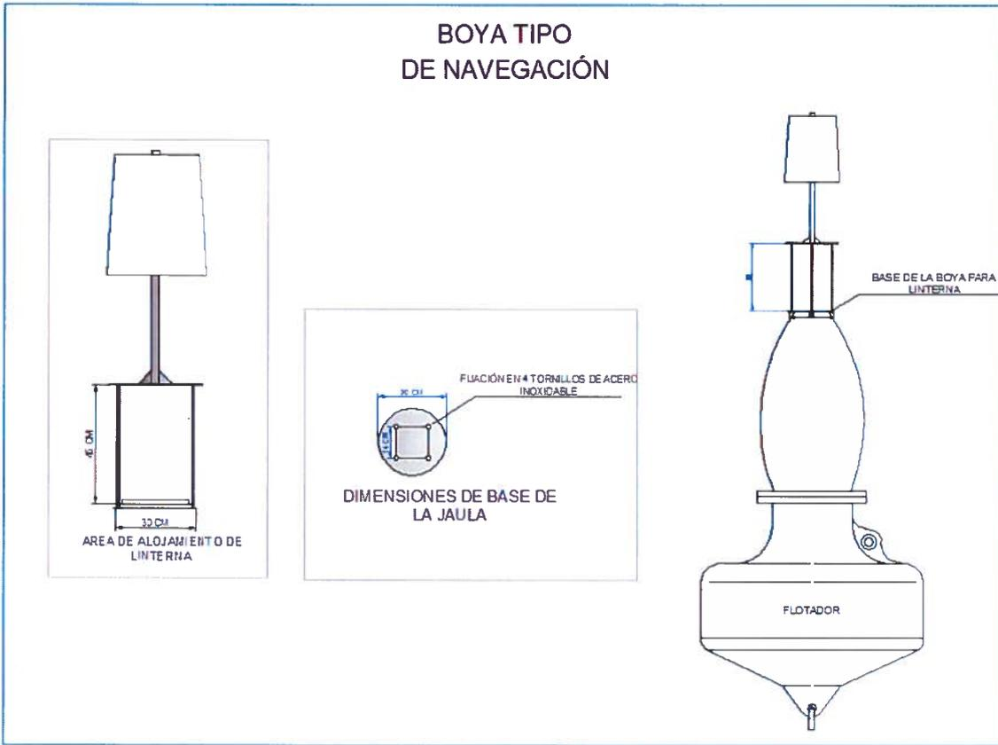
Figura 1. Boya de 1500 mm dm modelo SL-B1500
